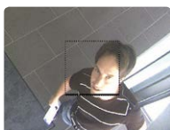
Ist das gepunktete Rechteck im Livebild sichtbar, ist die Kamera scharfgeschaltet
